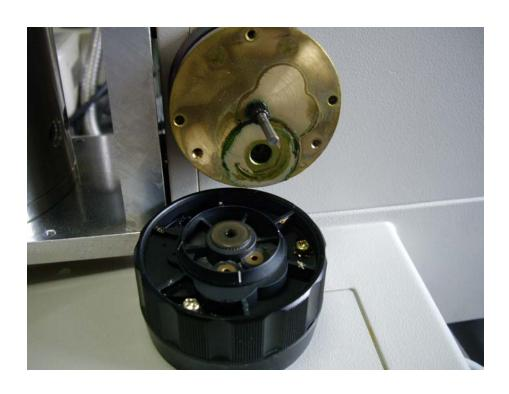
そこに直径3ミリの軸に破損したプラスチックのギアがついていますのでこれを交換していただきます。不良ギアが固着しているようでしたらカッターナイフで切り取ってください。引っ張っても抜けません。
