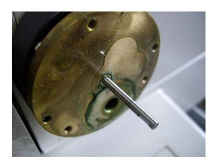
グリスなどを掃除していただき、微動用ギアをはめます。M2の芋ネジ(セットネジ)を十分緩めるか、外しておいてください。これは特に注意して下さい。
