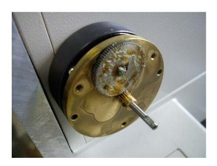
粗動ノブをはめてネジを3本締めます。粗動ノブがプラスチックですので割れますので、 適度に締めてください。菊座金が入っていますので少し締めれば十分とまります。締め すぎた状態ですと経年でひびが入ることがあります。
