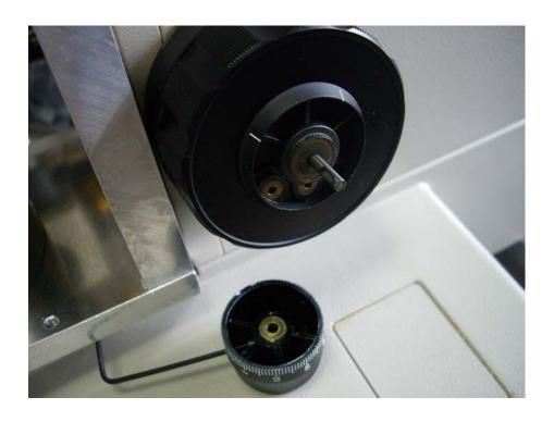
粗動ダイアルの化粧カバー(ドーナツ形状の薄板)をはがします。カッターナイフの刃をいれてはがします。接着されているだけです。
