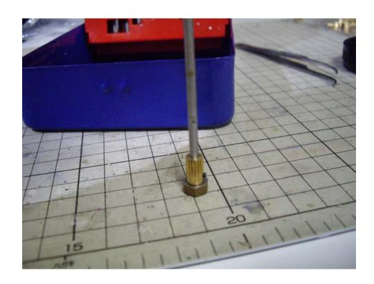
粗動の部内の平歯車を組み付けてください。粗動ノブに平歯車を入れたままでは絶対に、 粗動ノブをはめることができません。必ずこの写真のようにギアを組み合わせた状態に してください。セットネジは外側になるようにギアをはめます。
